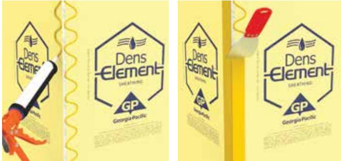
1. Appliquer le solin liquide DensDefy<sup>MC</sup> sur le coin intérieur ou extérieur dans un motif de zigzag ou de ruban.
